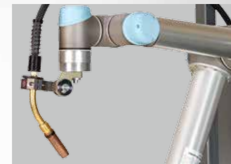
Alle onderdelen zijn van tevoren gemonteerd, inclusief de lastoorts van de robot. Installatie is niet nodig.
